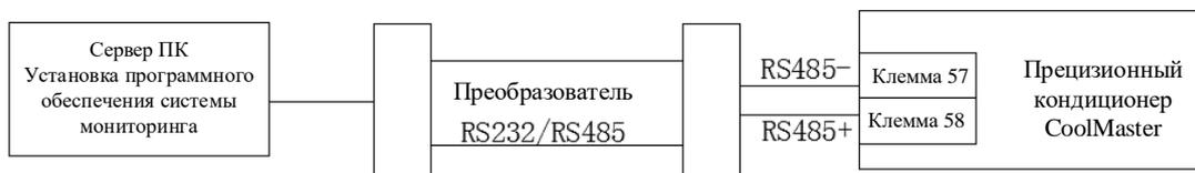
Рис. 3-4 Схема линии мониторинга
