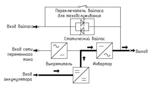
При **отключении сети** ИБП автоматически **переключается на аккумуляторное питание**. **Инвертор продолжает питать нагрузку** без перебоев.
