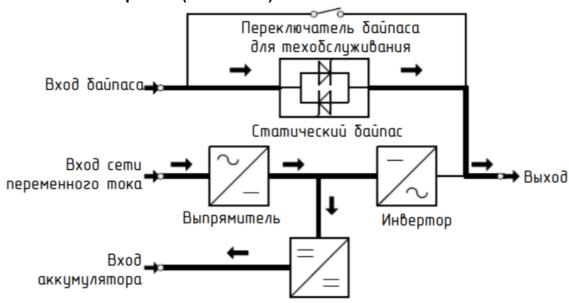
В этом режиме нагрузка питается напрямую от сети, **чтобы повысить КПД системы**. Если напряжение сети выходит за допустимые пределы, ИБП автоматически **переходит в инверторный режим**.
