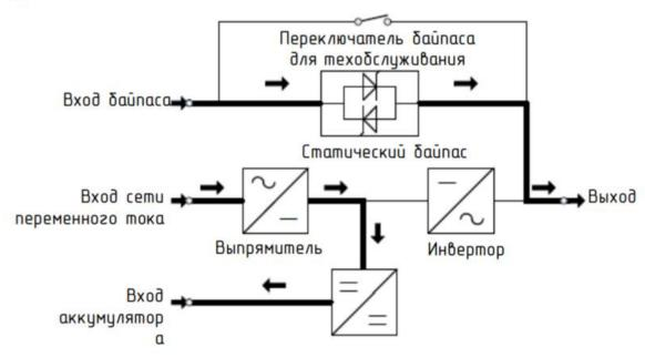
Если **инвертор выходит из строя** или **перегружается**, ИБП автоматически переключается в **режим байпаса**.
