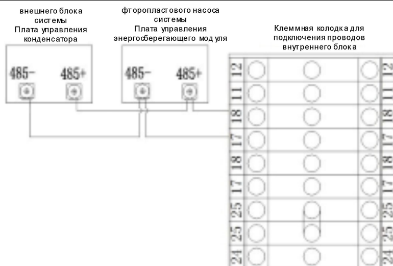
Рис. 3-1 Способ подключения линии связи RS485 прецизионного кондиционера с воздушным охлаждением/фторопластовым насосом с естественным охлаждением серии CoolRow
